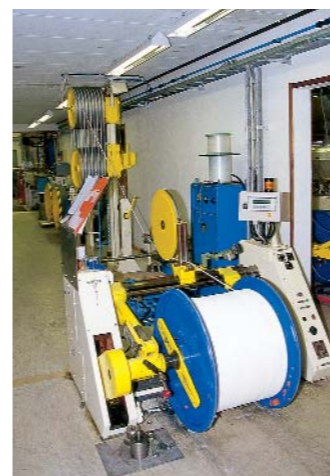
Eine solche Kabelfertigungsstraße ist über 20 Meter lang, hier entstehen gerade 3 Kilometer LS-Kabel
