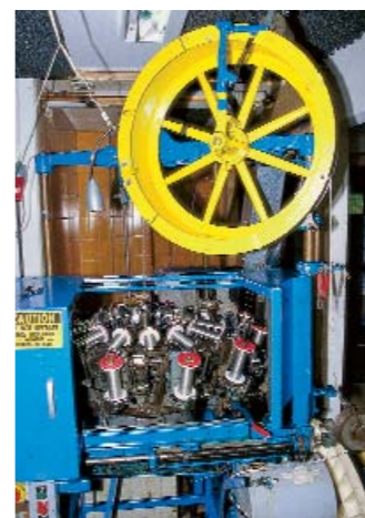
Die „Wickel-Station“ für das Supra Sword 3.0, in dem je Ader 12 Litzen hin- und 12 zurücklaufen
