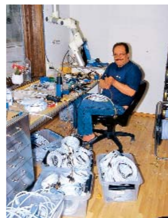
Die Konfektionierung der Kabel erfolgt natürlich in Handarbeit – nach strengsten Militär-Spezifikationen
