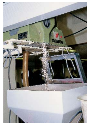
Das Kunststoffgranulat wird eingegeben, aus ihm besteht später der Kabelmantel
