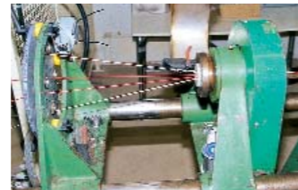
Verseilungsmaschine im Supra-Werk, bei der sich sogar die Abwickelspulen (nicht im Bild) mitdrehen
