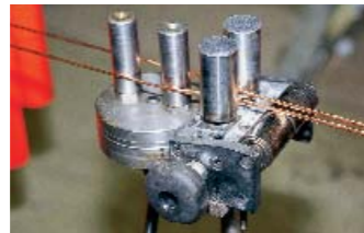
Fertigung eines einfacheren Steg-Lautsprecherkabels, das hier zur Ummantlungsstation gezogen wird
