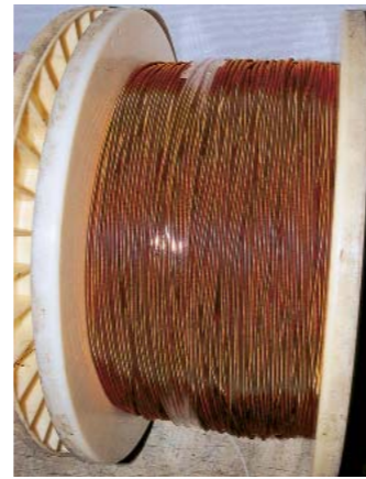
Nur so geht's: Angelieferte Innenwicklung für das Supra Sword 3.0 auf der Rolle
